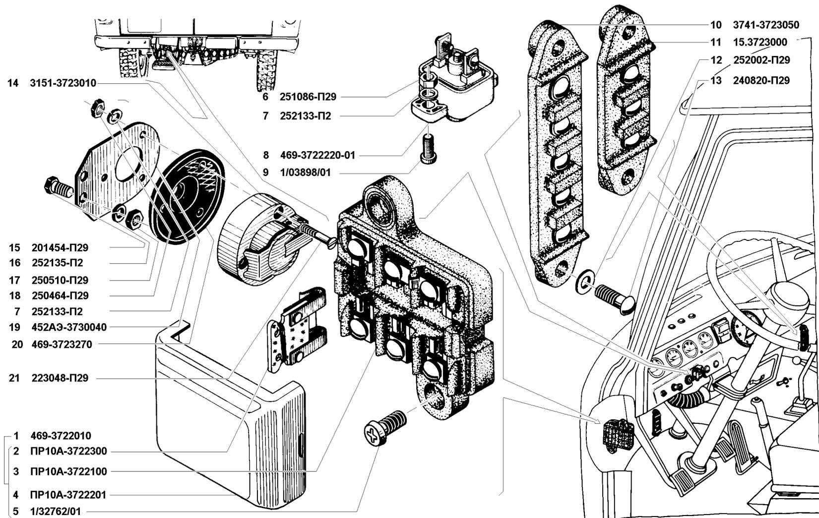
Рис. 108. Предохранители электрических цепей (3722) и соединители электропроводов (3723)
